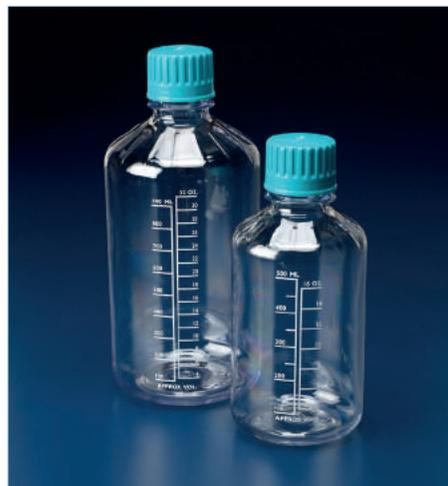
**i** Supportent jusqu'à 10 cycles en autoclave à 121°C
