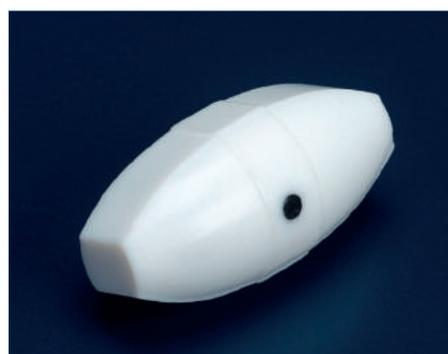
**i** Les barreaux d'agitation Turbo contiennent un aimant samarium-cobalt avec un pouvoir d'agitation accru. La puissante attraction du barreau d'entraînement peut provoquer un relargage de particules PTFE, du à l'abrasion entre l'agitateur et le fond du contenant.
